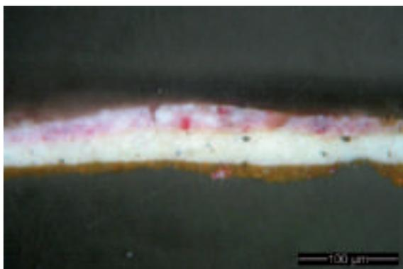
fig. 17 - Sezione stratigrafica del campione in cui si vede che il colore viola è composto da un unico strato applicato sopra l'imprimatura chiara che poggia sulla preparazione bruna
