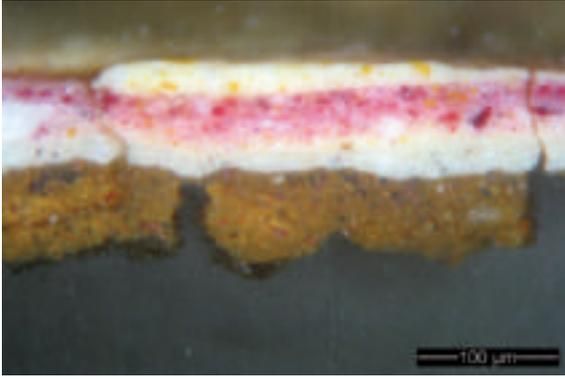
fig. 9 - Sezione di colore in cui si vede la preparazione bruna coperta dall'imprimatura chiara, le due stesure rosa dell'incarnato e il giallo del perizoma in superficie
